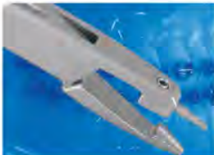
DO.710.200 Weingart Loop forming pliers with replaceable 440 stainless steel tip, three step tip has 1.14, 1.52 and 1.91mm diameters Kleszcze do formowania pętli z wymienną, trójstopniową końcówką (1.14 mm, 1.52 mm, 1.91 mm) ze stali nierdzewnej 440
