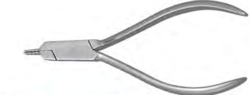
DO.688.300 Nance Loop forming pliers Four steps beak for making precision loops of 3.4, 5 or 6mm in round or rectangular wires. One tip is serrated to prevent wire slippage Kleszcze do formowania pętli Czterostopniowe dzioby dokładnie formują pętle 3, 4, 5 i 6 mm na lukach okrągłych lub prostokątnych. Jedna końcówka jest złobiona aby zapobiec wyslizgiwaniu się luku.
