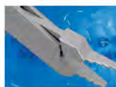
DO.688.300 Nance Loop forming pliers Four steps beak for making precision loops of 3.4, 5 or 6mm in round or rectangular wires. One tip is serrated to prevent wire slippage Kleszcze do formowania pętli Czterostopniowe dzioby dokładnie formują pętle 3, 4, 5 i 6 mm na lukach okrągłych lub prostokątnych. Jedna końcówka jest złobiona aby zapobiec wyslizgiwaniu się luku.
